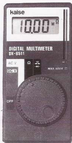
Figura 2.5. El polímetro incorpora un óhmetro para la medida de resistencias.
