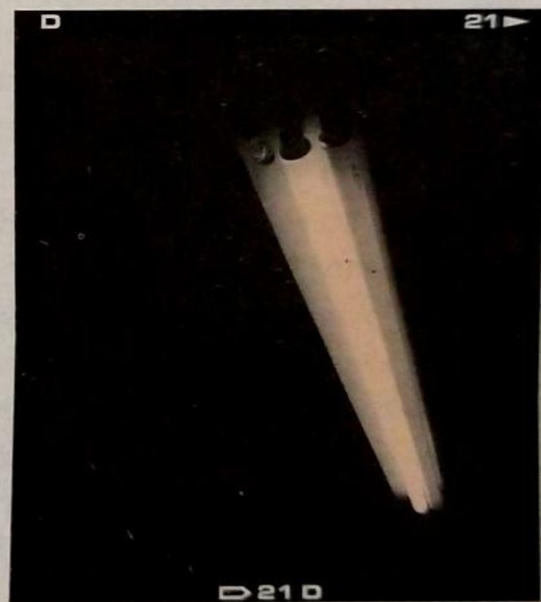
El estado eléctrico que alcanzan los gases en el interior de un tubo fluorescente los transforma en muy buenos conductores de la electricidad.
