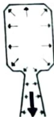
Fig. 14-6. Idea de un cohete. La eliminación de los gases provoca, por reacción, un desplazamiento.
