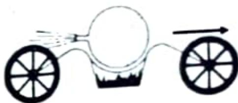
Fig. 14-5. Propulsión de reacción ideada por Newton.
