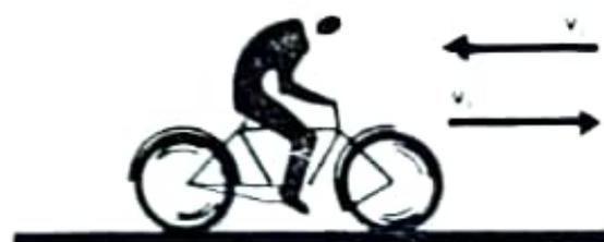
Fig. 14-10. Velocidades de sentido contrario. La resultante es la diferencia entre las mismas, con el sentido de la mayor.
