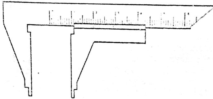
Fig. 1-3. Vernier. La corredera tiene 10 divisiones que corresponden a 9 de la regla mayor
